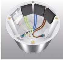
Geschirmte Gerätedosen verfügen über einen Anschlussdraht (transparent isoliert) mit Verbindung zur metallischen Außenbeschichtung. Dieser Anschlussdraht wird mit dem FPA im Verteilerkasten verbunden.
